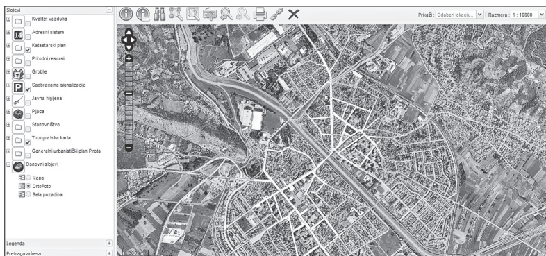
Слика 3. ГИС општине Пирот са представљеним катастарским планом, саобраћајном сигнализацијом, путевима, улицама и хидрографијом.
