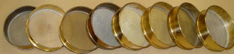
II. U međuvremenu priprema se kolona sita. Na vrh kolone se postavljaju sita sa najvećim otvorima, a ispod njih sa manjim.
