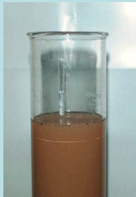
4. Nakon izvlačenja probe, suspenzija se sipa u porcelanski sud, koji se zagreva da bi voda isparila. Uzorak se potom suši u sušilici do konstantne mase.
