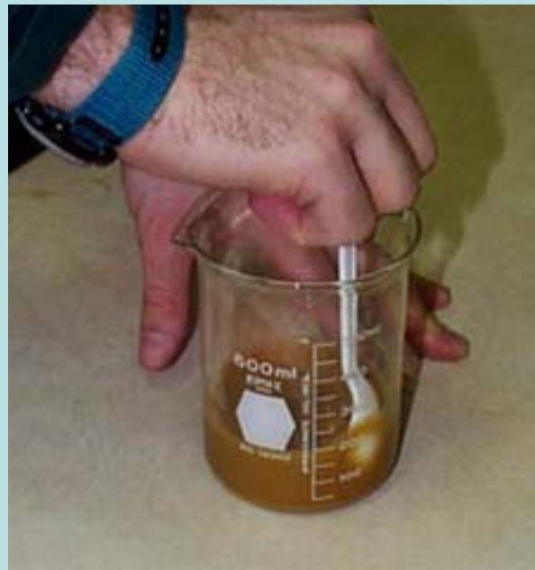
3. u tako nastalu pastu dodaje se ostatak rastvora, a potom i  $30$  do  $40\text{ cm}^3$  destilovane vode. Suspenzije se ostavi da odstoji 10 minuta.
