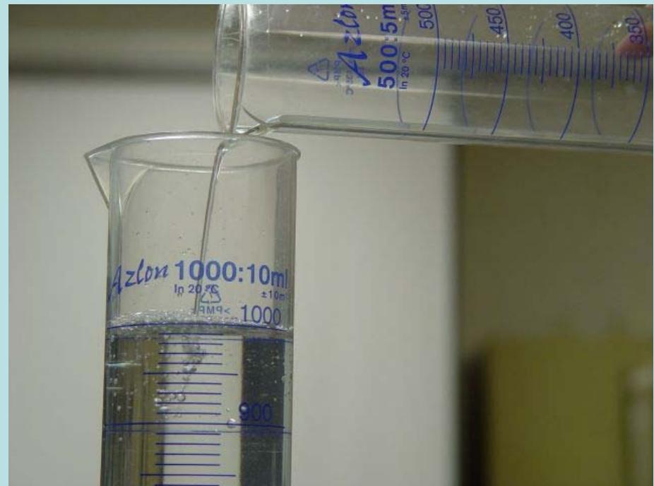
2. Probe se iz cilindra uzimaju pipetom zapremine  $25 \text{ cm}^3$ . Probe se uzimaju sa tačno određenih dubina i nakon tačno utvrđenog vremena.
