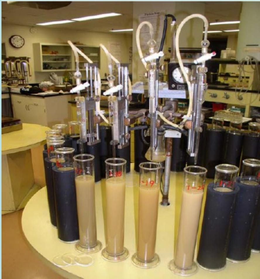
8. Nakon punjenja sadržaj pipete dovodi se do oznake od  $25\text{ cm}^3$ . Nakon toga suspenzija se prenosi u porcelansku posudu koja se zagreva da bi isparila suvišna voda. Uzorak se suši u sušilici do konstantne mase i meri. Sadržaj frakcije izračunava se u procentima od ukupne mase uzorka.
