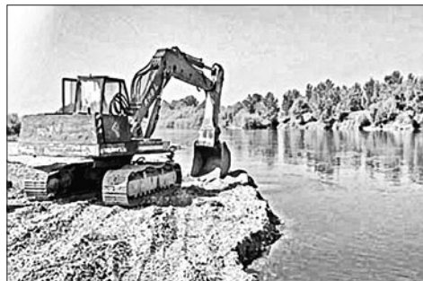
Слике 1 и 2. Експлоатација песка и шљунка из корита Велике Мораве применом сувоземне механизације
