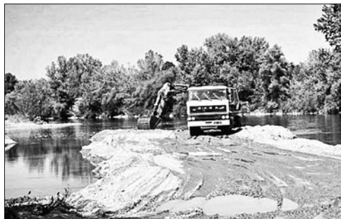
Слике 1 и 2. Експлоатација песка и шљунка из корита Велике Мораве применом сувоземне механизације
